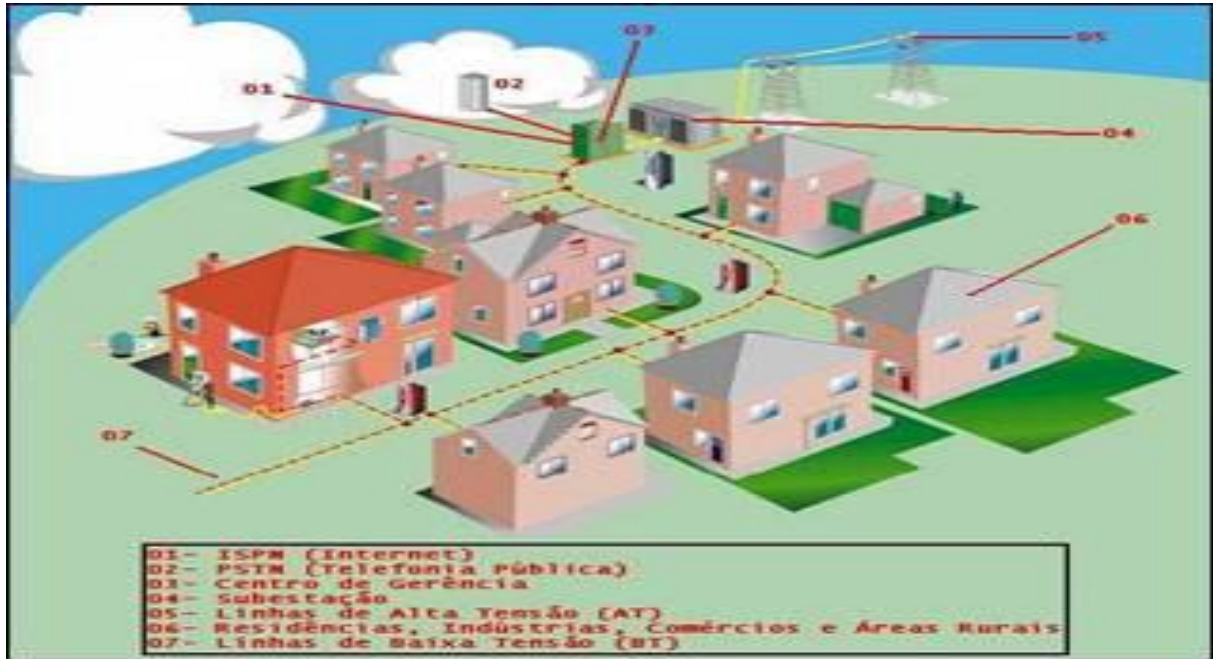
Figura 2: Células PLC (Fonte: VARGAS, 2015).
